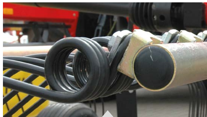
Lateral do braço que fica em contato com a cultura completamente liso
